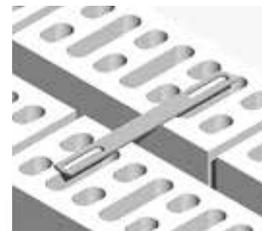
Murfor®Anc Joint+ 200. Llave deslizante, juntas de dilatación
