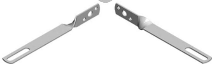
El extremo a fijar sobre el soporte es el menor embebiendo en mortero la parte larga del anclaje. El extremo corto se debe fijar a la estructura mediante un elemento que garantice la transmisión de esfuerzos. Se aconseja la utilización de tacos de expansión de métrica M-8, situados en el agujero central.
